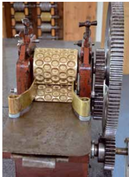
Der Walzenstuhl mit zwei Bonbonwalzen ist mit rund 120 Jahre ein Museumsstück und stammt aus Südtirol
