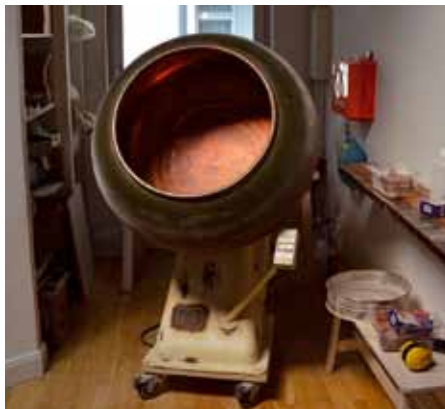
Im Dragierkessel werden die Bonbons meliert, das heißt mit Puderzucker oder anderen guten Dingen überzogen
